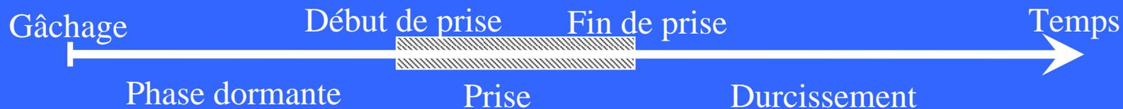
**Début et fin de prise** : après une ou deux heures pour la plupart des ciments, on observe une augmentation brusque de la viscosité : c'est le début de prise, qui est accompagné d'un dégagement de chaleur. La fin de prise correspond au moment où la pâte cesse d'être déformable et se transforme en un matériau rigide.
