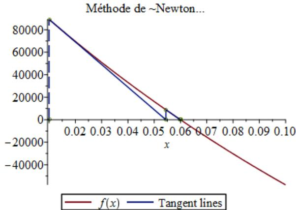
À partir du point initial  $x = 0.01$ , au moins 4 iteration(s) de la méthode de Newton pour
