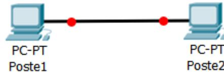
La couleur rouge (aux extrémités du câble) indique qu'il y a un problème dans l'installation de votre réseau. Il s'agit ici du fait qu'un câble réseau droit a été utilisé. Pour relier des postes directement entre eux, il faut utiliser un **câble croisé**. Modifiez votre réseau : effacer le câble droit (utilisez la touche « **suppr** ») et remplacez-le par un câble croisé.
