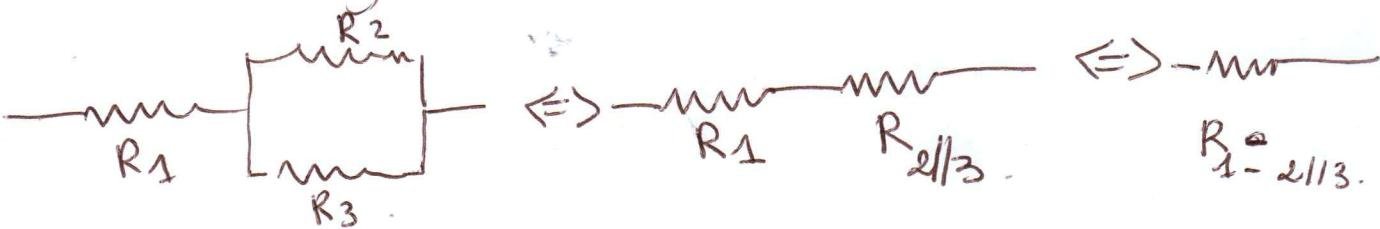
$$R_2 \text{ et } R_3 \text{ sont en parallèles.} = R_{2/3}$$
