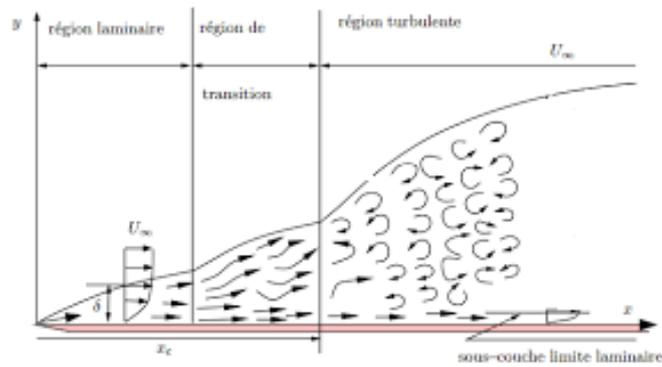
Figure 3. Couche limite laminaire et turbulent
