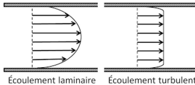
Figure 2. Profile d'un écoulement établi laminaire et turbulent
