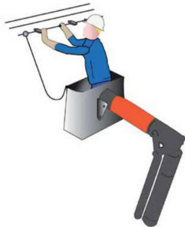
Figure III.19 Travail au contact : exemple pour la basse tension et la haute tension A
