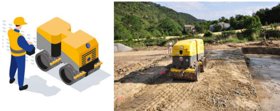
Figure IV.10 : Réduction des vibrations par utilisation d'engins téléguidés
