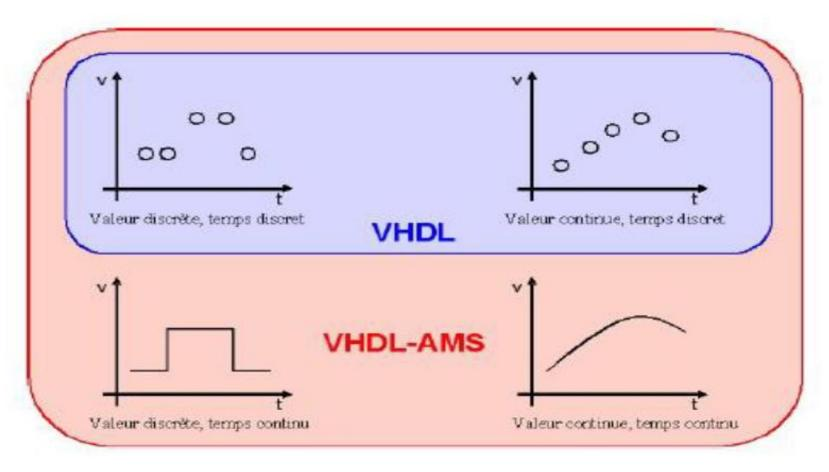
Fig. 1: Couverture du langage VHDL-AMS.
