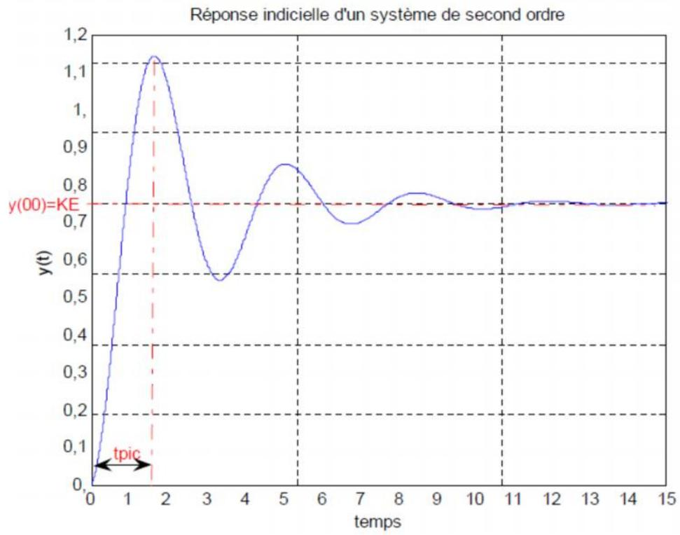
C'est un système oscillant amorti.
