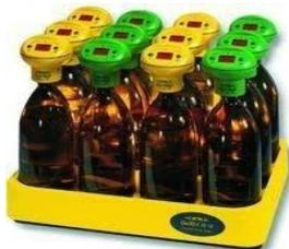
Figure 15 : Bouteilles DBO
