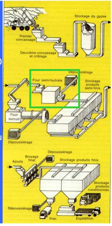
Cuisson par voie sèche: elle est pratiquée pour obtenir la plus grande partie du plâtre. Elle permet d'obtenir le semi-hydrate β, grâce à des températures variant entre 110 à 180°c dans des fours discontinus à chauffage indirect. Il est composé de 94% de CaSO<sub>4</sub> et 6% de H<sub>2</sub>O de cristallisation.
