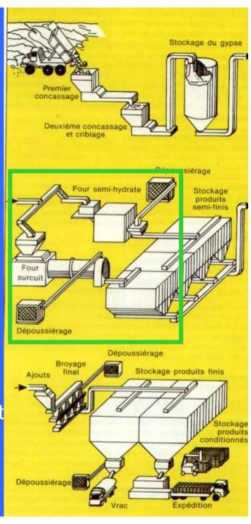
Le surcuit ou anhydrite insoluble (CaSO<sub>4</sub> II), obtenu par cuisson à des températures variant entre 400 à 600°c dans des fours continus à chauffage direct. sous cet aspect, il est encore capable de faire prise en se combinant à l'eau (plâtre hydraulique), mais dans des délais longs (d=2,93 à 2,97). Inutilisable seul; on l'ajoute au semi hydrate dans une proportion de l'ordre de 30% pour la fabrication des plâtres pour enduits.
