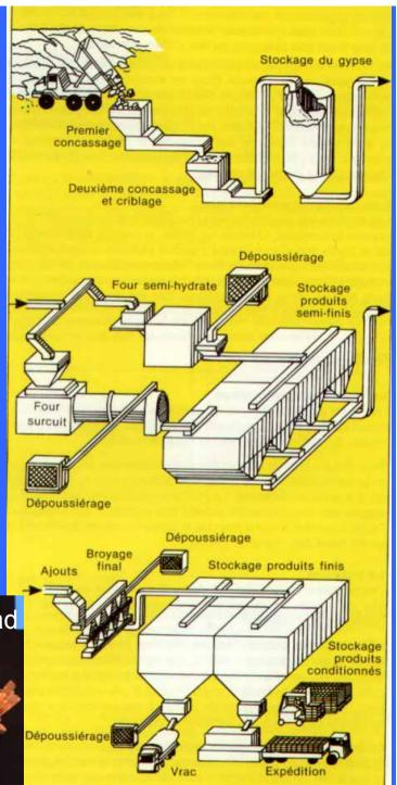
Les blocs de gypse extraits des carrières sont fragmentés en morceaux de plus en plus petits par des passages dans divers concasseurs à mâchoires, à cylindres ou à percussions. Pour réduire ensuite le grain des pierres obtenu par concassage, on procède à un broyage primaire à l'aide de broyeurs à percussion ou à marteaux oscillants.
