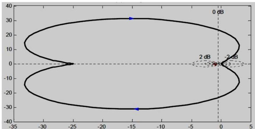
Le système n'est pas stable en boucle fermée
