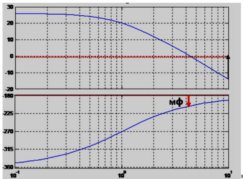
Le système est instable en BF car  $MG > 0$  et  $M < 0$
