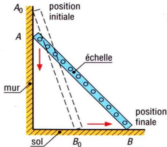
Fig. 1.8 Glissement d'une barre dans un plan
