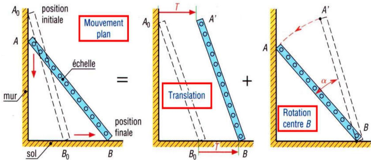
Fig. 1.6 Mouvement plan
