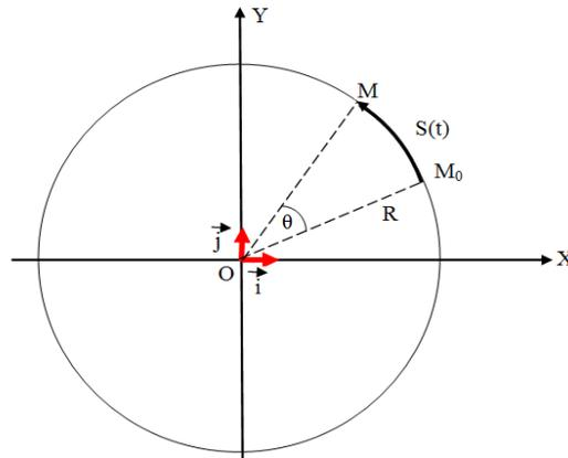
Fig. 1.5. Mouvement de rotation
