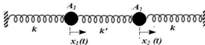
Fig. 6.3 Pendule élastique double
