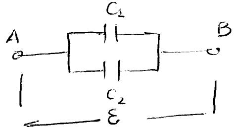
\* La d.d.p est la même pour les deux condensateurs et égale à la tension de la source  $E$ .
