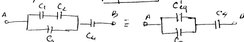
\*  $(C_{eq}, C_3)$  : sont en parallèles :  $C''_{eq} = C_3 + C_{eq} = (6 + 2,5) \cdot 10^{-6}$
