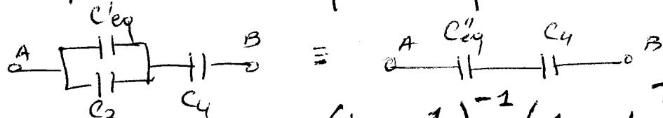
\*  $(C''_{eq}, C_4)$  : sont en série :  $C_{eq} = \left( \frac{1}{C_4} + \frac{1}{C''_{eq}} \right)^{-1} = \left( \frac{1}{20} + \frac{1}{8,50} \right)^{-1} \cdot 10^{-6}$
