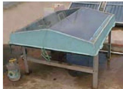
Figure 9: présentent le principe et l'exemple d'un distillateur solaire à effet de serre
