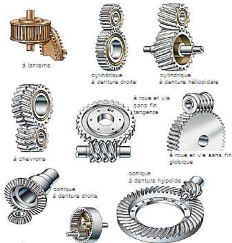
**Figure II-22 :** Différents types d'engrenage.
