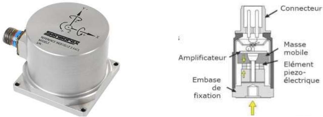
**Figure II.8 :** Schéma de principe d'un accéléromètre.
