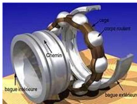
**Figure II-23 :** Constitution d'un roulement.
