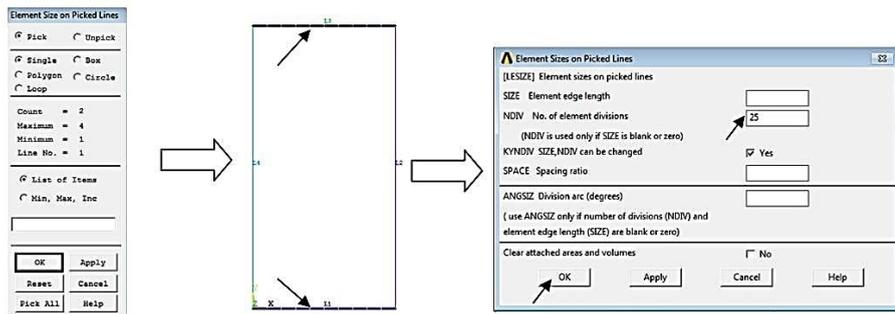
✓ **Preprocessor > Meshing > Size Contls > Lines > Picked Lines > (Cliquer sur les deux lignes verticales) >OK**
