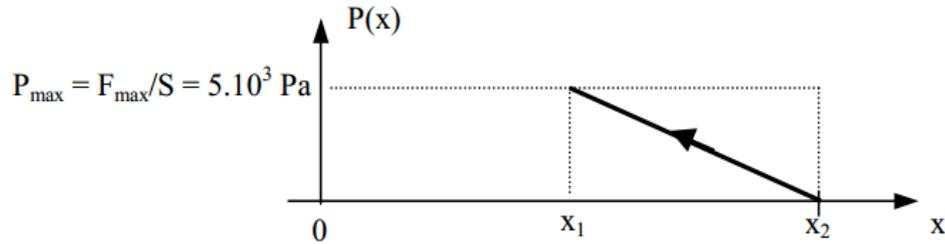
2. On a pour la position  $x$  le volume  $V$  de cylindre donné par  $V = S \cdot x$ , il suffit donc de remplacer l'échelle horizontale des  $x$  par  $S \cdot x = 20 \cdot 10^{-4} \cdot x$ , d'où le graphe ci-dessous :
