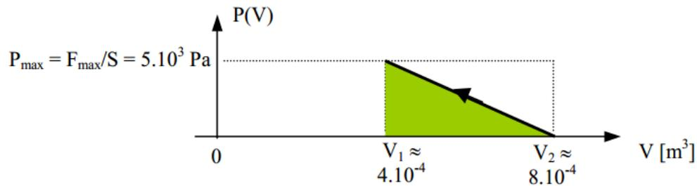
L'expression de  $P$  en fonction de  $V$  est donnée par  $P = -\left(\frac{P_{\max}}{V_2 - V_1}\right)V + 2P_{\max}$
