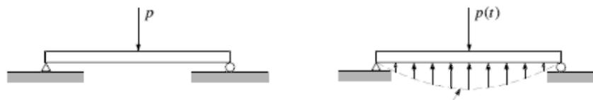
Figure II.38. L'apparition de force d'inertie sous l'effet d'une charge dynamique.
