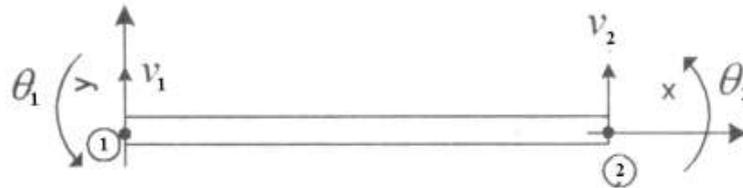
Figure VIII.18. Élément poutre en présence des déplacements et des rotations.
