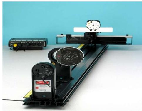
**I.2 Observer et mesurer** Placez la roue à une seule fente. Il faut interposer les différentes fentes, de largeurs connues  $a$ , à une distance **constante** (quelques cm) du laser, la distance  $D$  ayant été mesurée et devant rester constante également.
