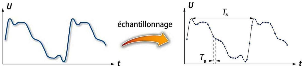
Figure 10- Etape D'échantillonnage
