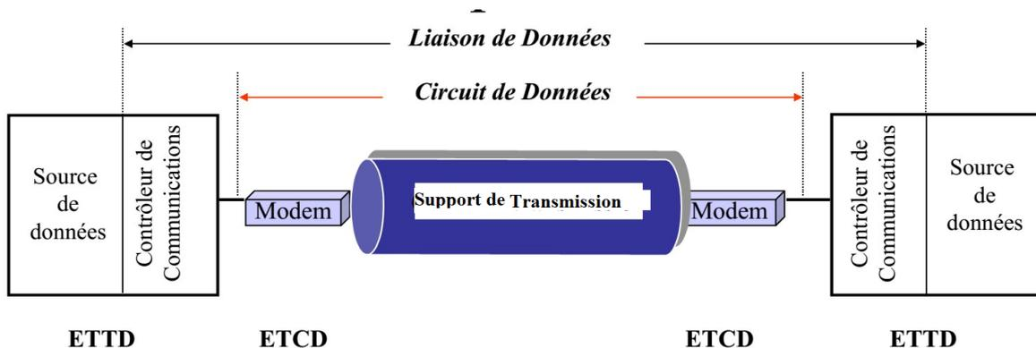
Figure 5 - Schéma d'une liaison de donnée (Équipements voisins)
