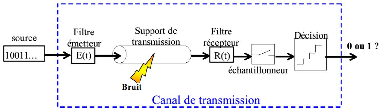
Figure 4 - Schéma d'un canal de transmission numérique
