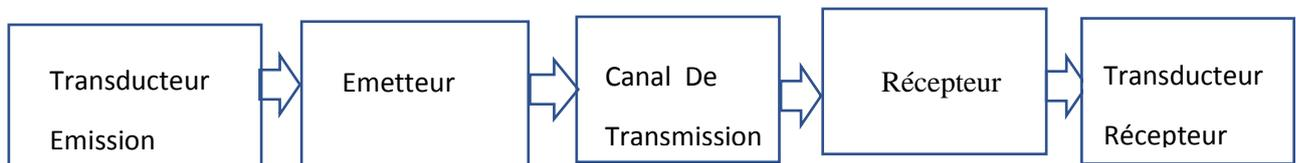
Figure 1 Principe de la chaîne de transmission de l'information
