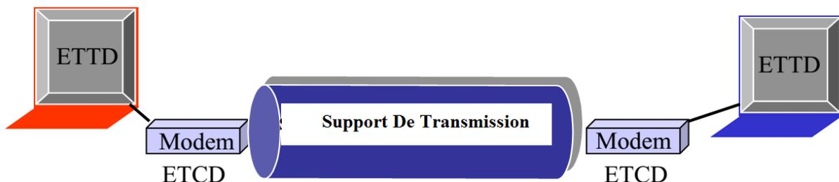
Figure 6 - Schéma d'une liaison de donnée (Équipements distants)
