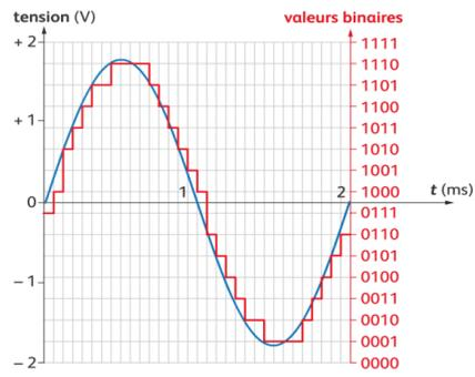
**Figure 12-Quantification d'un signal analogique sur 4 bits**
