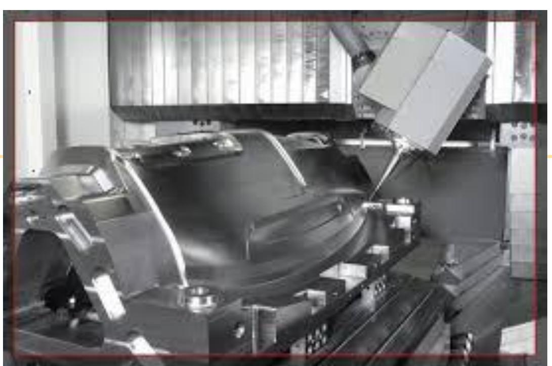
Bien que les machines 5 axes et les systèmes de FAO avec des fonctionnalités 5 axes existent depuis de nombreuses années, ce n'est que depuis peu que les deux sont utilisés pour la fabrication de moules et de matrices. Les défis auxquels sont confrontés les programmeurs en FAO 5 axes impliquent plus que la création de parcours de FAO 5 axes sans collision.
