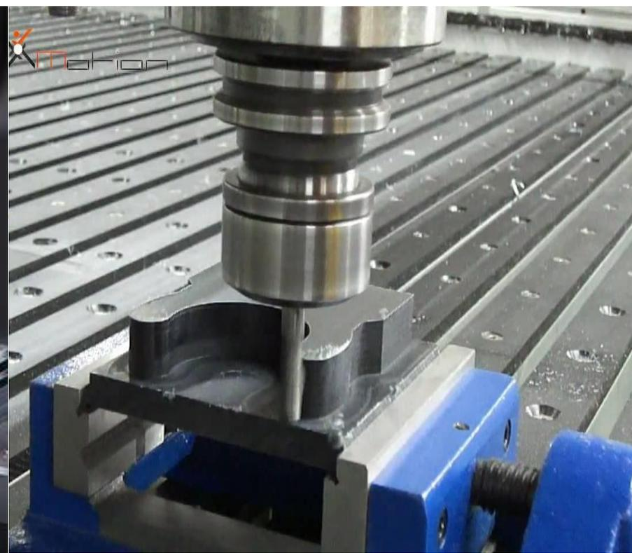
Les parcours 3 axes sont suffisants tant que la pièce n'est pas trop profonde par rapport au diamètre de l'outil. Si la pièce est très profonde et présente des cavités étroites, l'utilisation d'un simple parcours 3 axes n'est pas suffisante pour réaliser la finition complète de la pièce.
