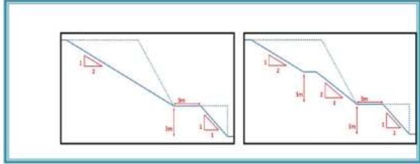
التبديل (La Substitution): يتم تبديل المواد الهشة بالمواد المقاومة عن طريق تنظيف المنحدر
