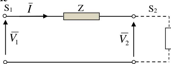
Figure 3.1 : Schéma monophasé équivalent
