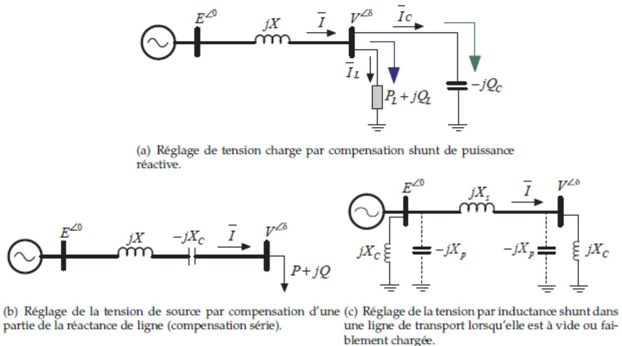
Figure 3.9 : Réglage Indirecte de la tension
