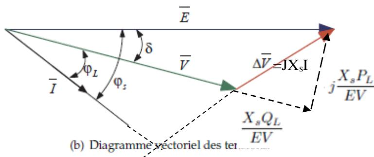
Figure 3.5 : Diagramme vectorielle des tensions
