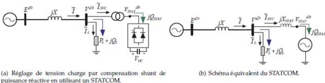
**Figure 3.11** : Réglage de la tension par un STATCOM
