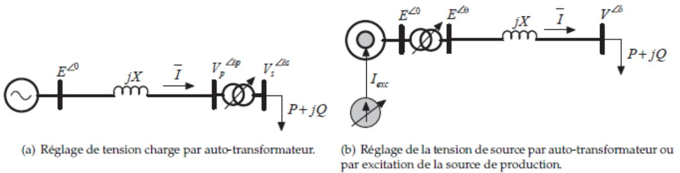
**Figure 3.8** : Réglage direct de la tension
