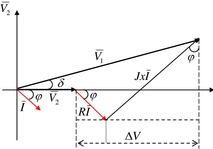
Figure 3.2 : Diagramme de tension (forme générale)
