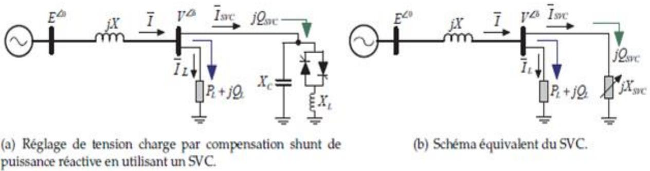
**Figure 3.10** : Réglage de la tension par SVC
