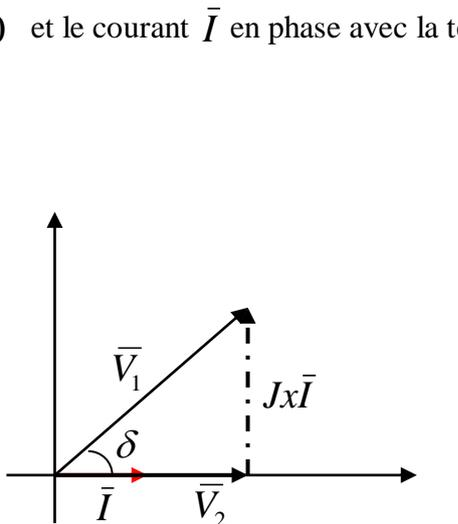
Figure 3.3 : Diagramme de tension simplifié
