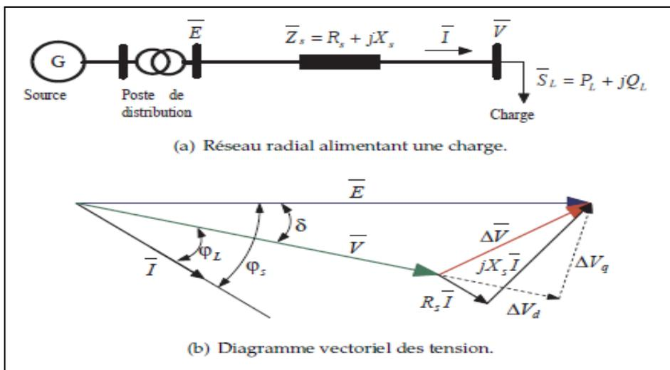
**Figure 3.4 : Chute de tension dans une ligne.**
