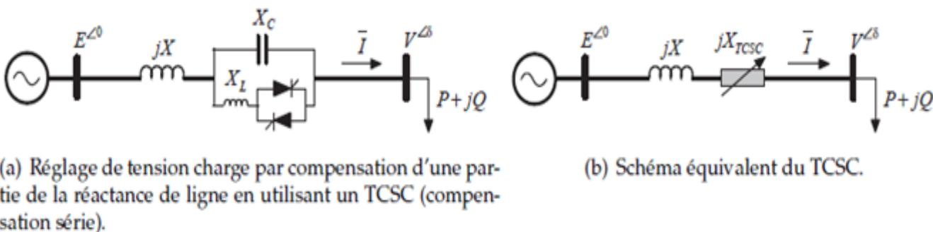
**Figure 3.12** : Réglage de la tension par un TCSC
