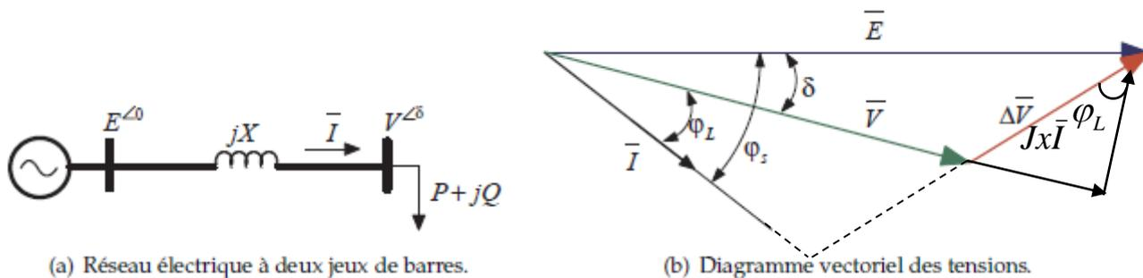
Figure 3.7 : Réseau à deux jeux de barres
