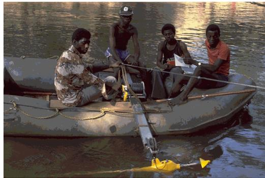
*Fig. 3.5 - Jaugeage au moulinet à l'aide d'un bateau.*
