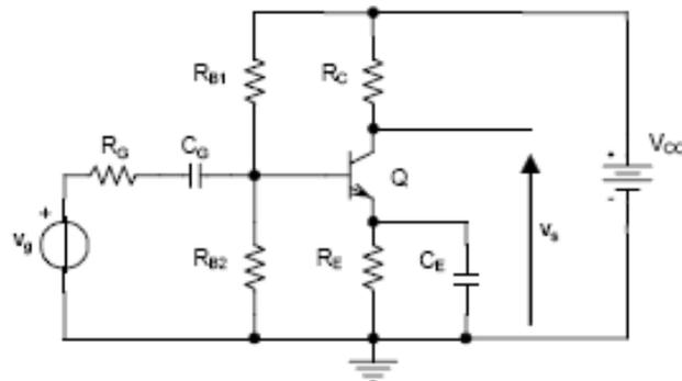
Le condensateur  $CG$  assure la liaison de l'étage avec le générateur. Le rôle du condensateur  $CE$  est de découpler la source par rapport à la masse. En régime statique, **les condensateurs sont équivalents à des circuits ouverts**. En régime dynamique et aux fréquences de travail du montage, ces condensateurs doivent se comporter comme **des courts-circuits**. De ce fait, la topologie diffère selon le régime à étudier.
