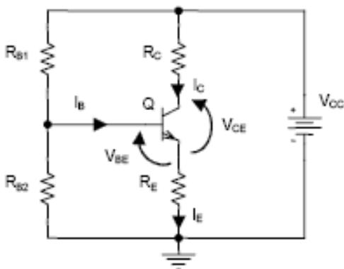
$$\begin{cases} V_B = R_{B1} I_B + V_{BE} + R_E I_E \\ V_{CC} = R_C I_C + V_{CE} + R_E I_E \end{cases}$$
