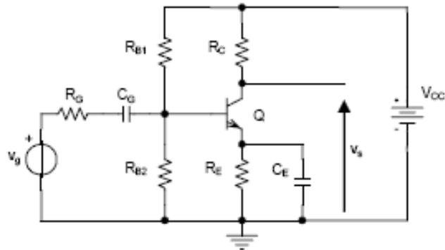
En régime actif linéaire, une petite variation  $v_{BE}$  de  $V_{BE}$  entraîne une petite variation  $i_B$  de  $I_B$ , ce qui entraîne une variation  $i_C$  de  $I_C$  et une variation  $i_E$  de  $I_E$  (voir la figure)
