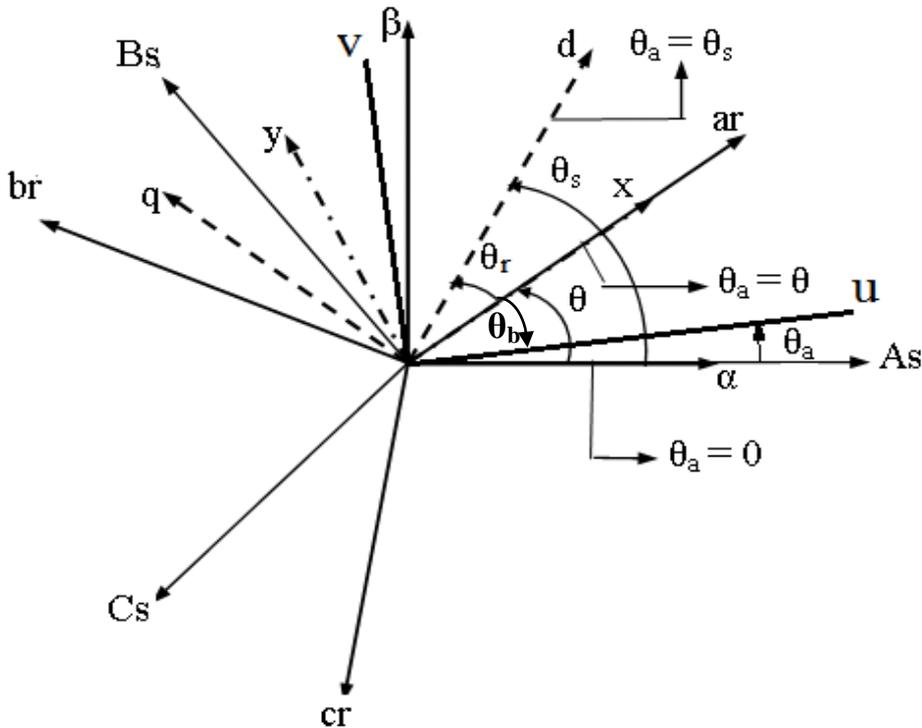
Figure 1. : Passage du système triphasé au système biphasé et inversement pour une MAS
