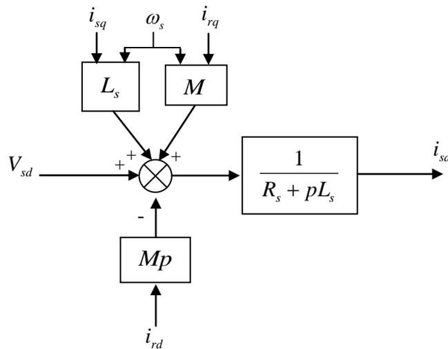
Figure 2. Schéma fonctionnel fréquentiel du modèle électrique statorique de la MAS selon l'axe (d) ( $i_{sd} = f(V_{sd}, i_{rd}, i_{sq}, i_{rq}, \omega_s)$ )
