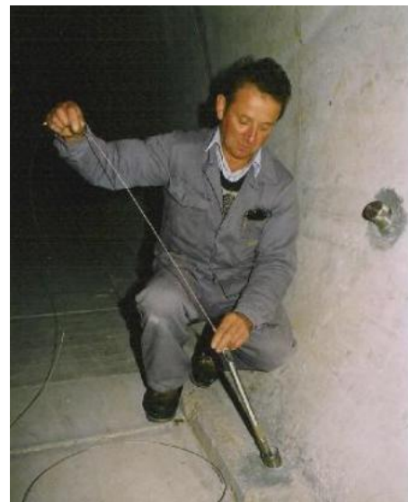
Figure 1.13-1: Introduction d'un thermomètre normal dans un forage
