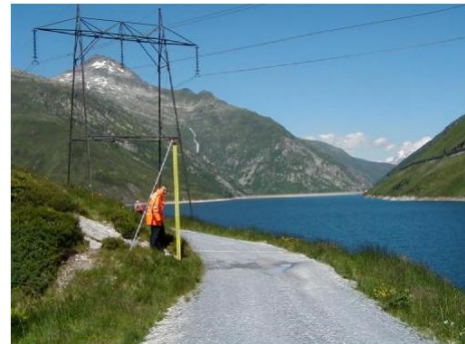
Figure 2.05-2: Mire de nivellement de 3 m
