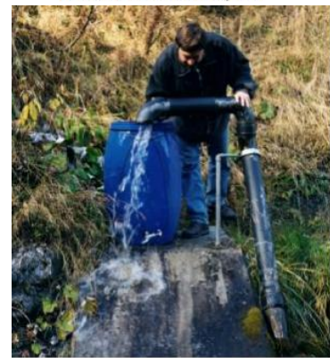
Figure 3.01-2 Mesure volumétrique d'un débit important au moyen d'un tuyau pivotable
