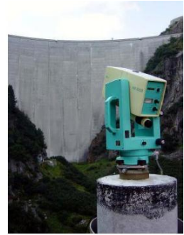
Figure 2.01-2: Instrument de précision de mesure de distance ME5000
