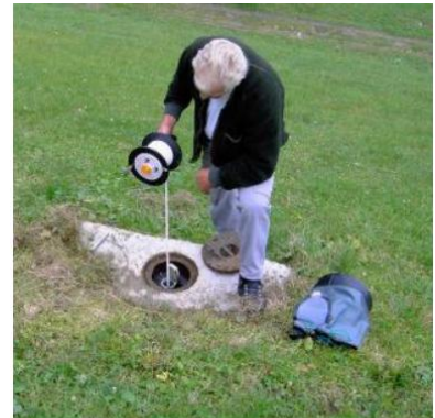
Figure 3.05-2: Mesure du niveau d'eau dans un tube piézométrique au moyen d'un câble avec témoin lumineux
