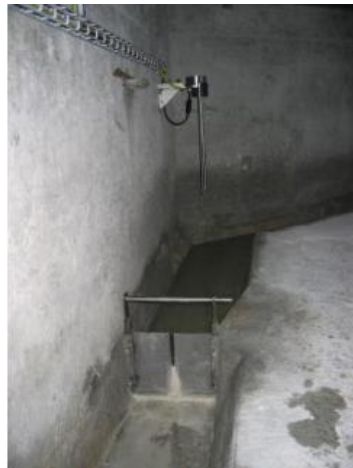
Figure 3.02-2: Déversoir avec sonde à ultrasons
