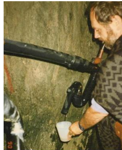
Figure 3.01-1 Exécution d'une mesure volumétrique chronométrée avec un récipient
