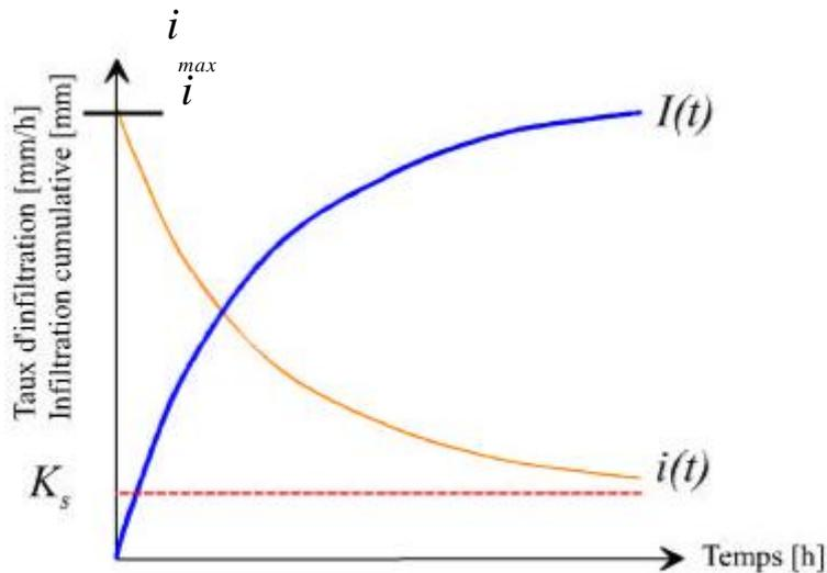
Figure 11: Évolution générale du régime d'infiltration et de l'infiltration cumulative au cours du temps ( $K_s$  = conductivité hydraulique à saturation)
