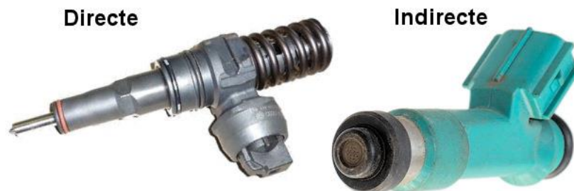
Figure I.6 : Injecteurs pour injection directe et injection indirecte
