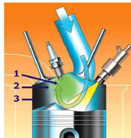
Figure I.24. Propagation de la combustion dans le cas d'une charge stratifiée
