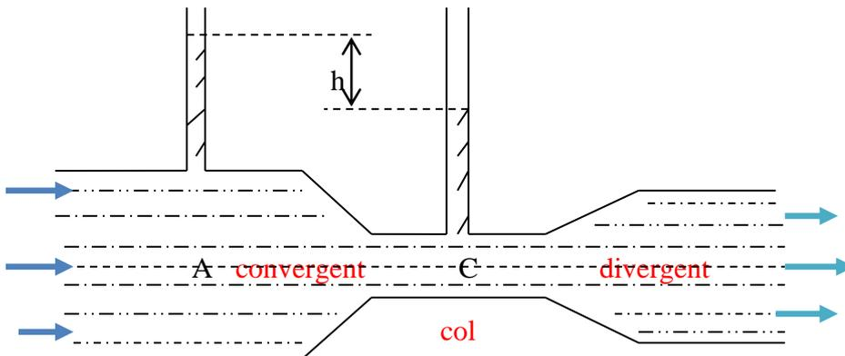
Pour calculer la différence de pression entre le convergent et le col en applique l'équation de Bernoulli pour une ligne de courant entre les points A et C :
