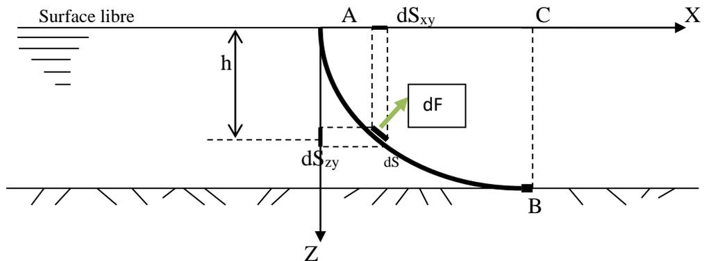
Le Principe reste le même : sur chaque élément de surface s'exerce une force  $d\mathbf{F} = \mathbf{P} d\mathbf{S}$  ; normale à cet élément. Considérons la paroi cylindrique (AB) à plan vertical (Cad : 1/4 de cercle), soit AB une paroi cylindrique perpendiculaire au plan du dessin.
