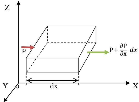
En dynamique des fluides pour un fluide parfait incompressible en mouvement, l'équation d'Euler (équation de mouvement) devient :
