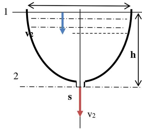
s << S donc  $V_1 \ll V_2$  (on considère que  $\frac{V_1^2}{2g}$  est négligeable devant  $\frac{V_2^2}{2g}$ )
