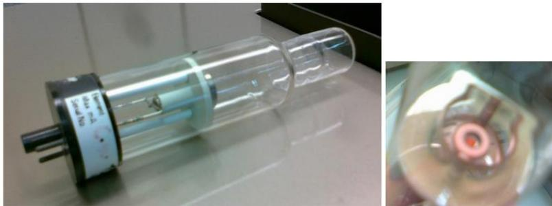
*Illustration:* Lampe à cathode creuse de cuivre
