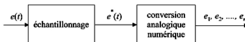
Figure.1.2 Échantillonnage et conversion analogique numérique d'un signal.
