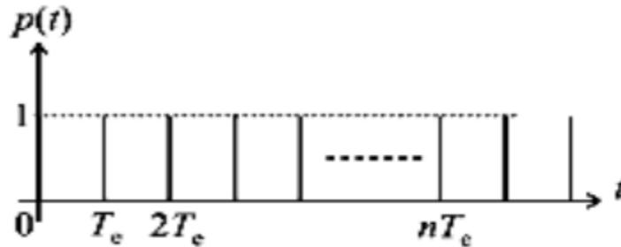
Figure.1.3 Fonction d'échantillonnage
