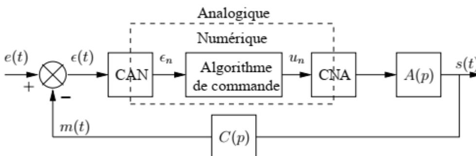
Figure. 1.1 Structure de la réalisation d'un asservissement numérique
