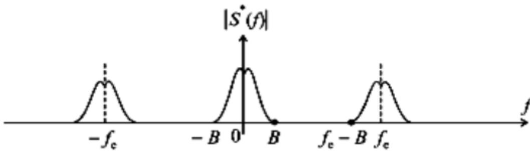
Figure.1.5 Spectre d'un signal échantillonné.
