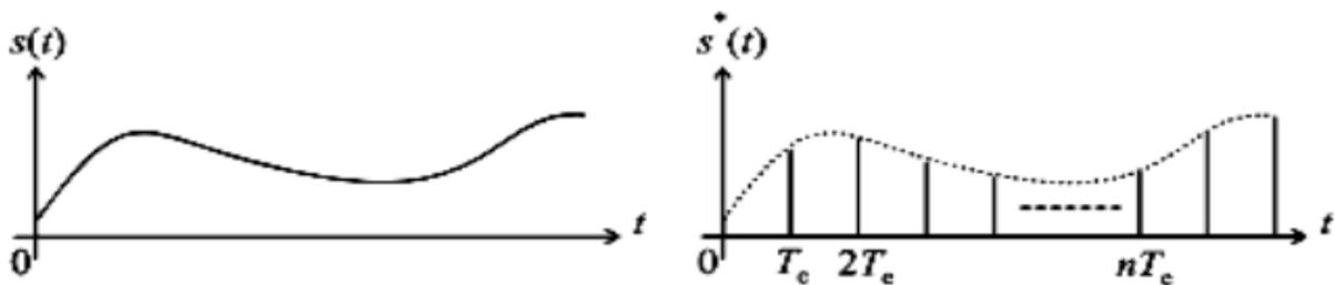
Figure.1.4 Echantillonnage d'un signal quelconque.
