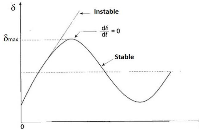
Figure 5. Evolution temporelle de l'angle de rotor ou angle de puissance ( $\delta$ ) pour un system stable et un système instable après une perturbation.
