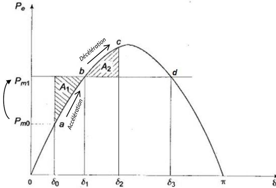
Figure 7. Principe de la méthode des aires égales appliquée à un générateur synchrone connectée à un réseau électrique infini, après application d'une augmentation rapide de la puissance mécanique d'entrée
