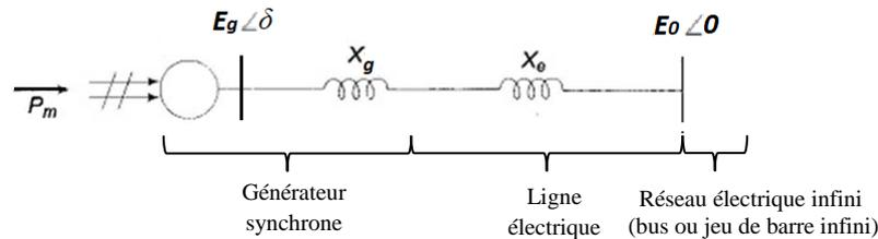
Figure 6. Machine synchrone connectée à réseau électrique infini (bus ou jeu de barre infini)
