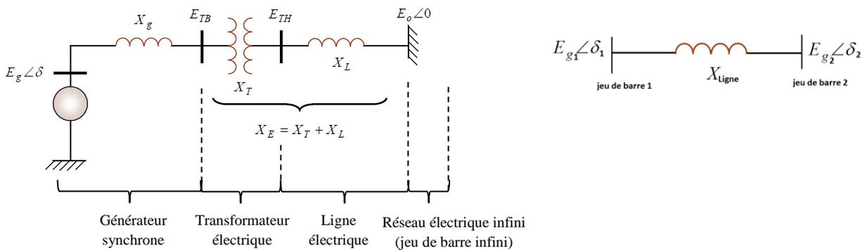
Figure 3. a. Machine synchrone connectée à un jeu de barre infini , b. jeu de barre 1 connecté à un jeu de barre 2
