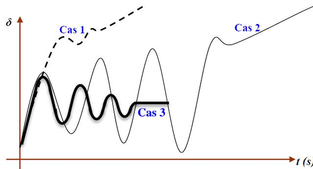
Figure 2. Variation d'angle de rotor.
