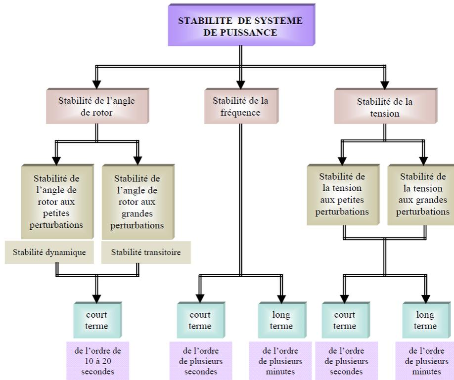
Figure 1. Classification des différents types de la stabilité de système de puissance.
