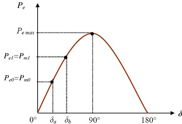
Figure 4. Relation puissance électrique produite-angle de rotor.
