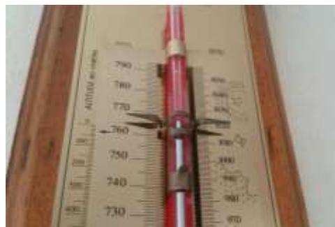
Baromètre à mercure de Torricelli
