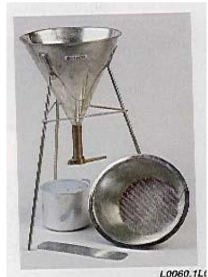
Fig. Appareil pour densité apparente
