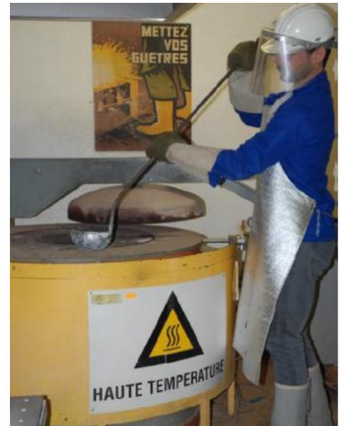
Figure 16. Prélèvement de l'alliage liquide
