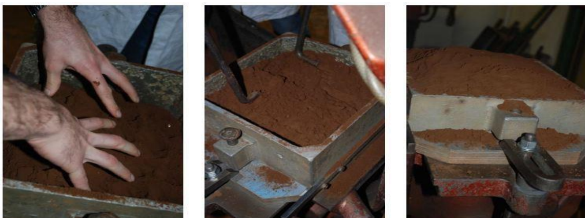
Figure 6. Remplissage du châssis avec le sable à vert
