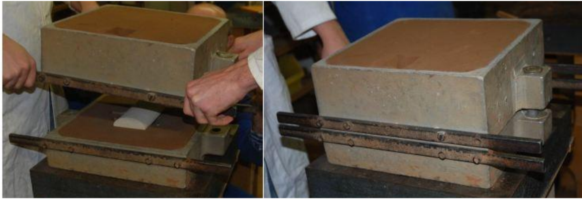
Figure 15. Assemblage des deux châssis
