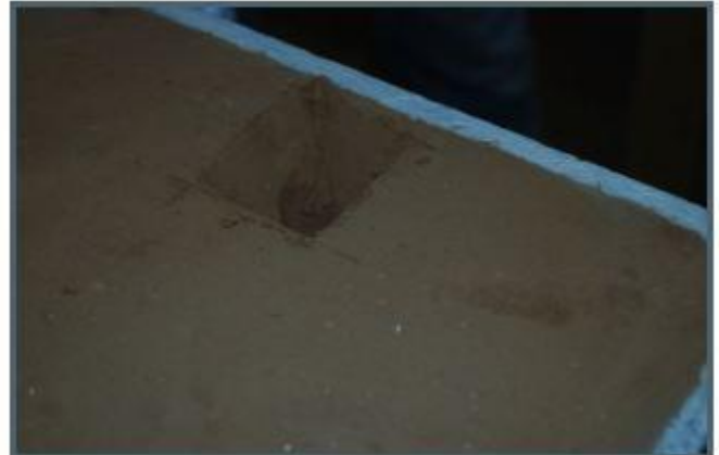
Figure 13. Finition du trou de coulée
