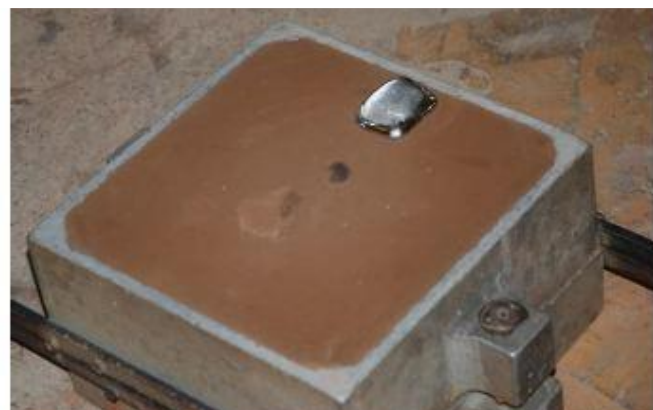
Figure 17. Coulée et remplissage du moule
