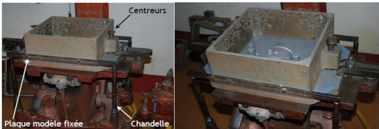
Figure 5. Plaques modèle fixée sur la machine et le châssis positionné
