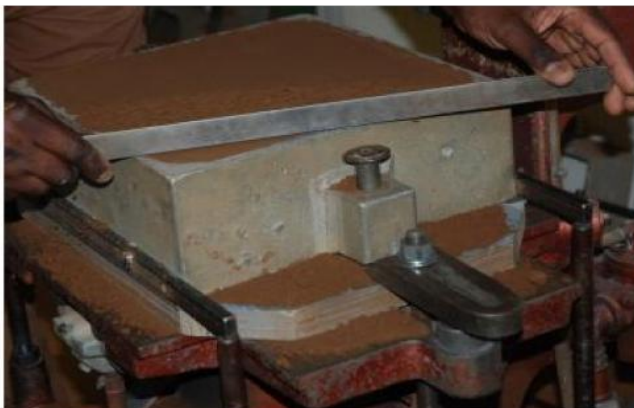
Figure 8. Arasement du sable
