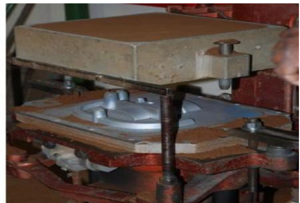
Figure 9. Montée du châssis, libération des plaques modèle
