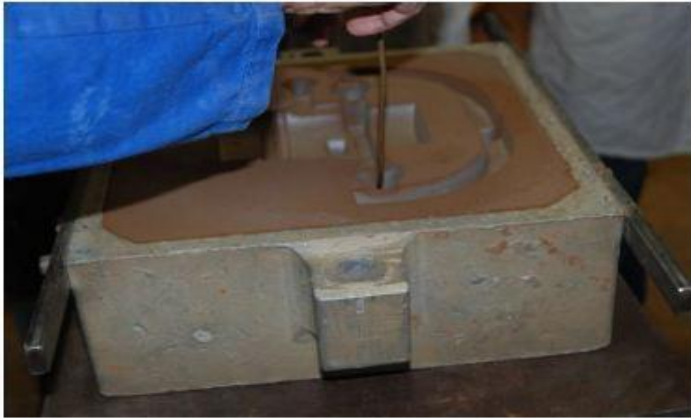
Figure 11. Réalisation des évents à l'aiguille
