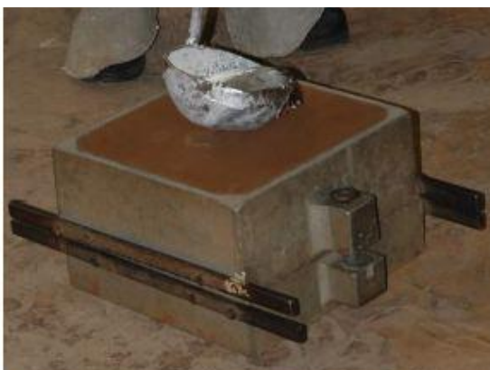
Figure 17. Coulée et remplissage du moule
