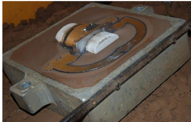
Figure 19. La pièce et son noyau dans le châssis supérieur
