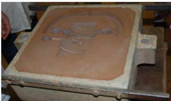
Figure 10. Empreintes dans les châssis, la couleur argentée est un résidu de l'agent démoulant
