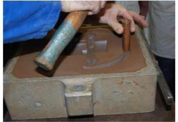
Figure 12. Prolongation du trou de coulée
