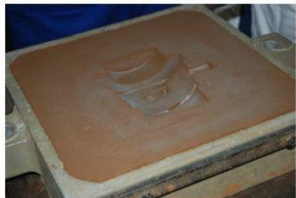
Figure 10. Empreintes dans les châssis, la couleur argentée est un résidu de l'agent démoulant
