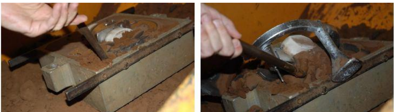
Figure 19. La pièce et son noyau dans le châssis supérieur
