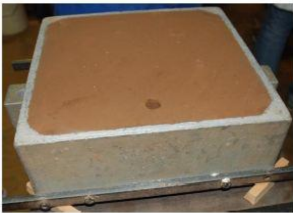
Figure 13. Finition du trou de coulée
