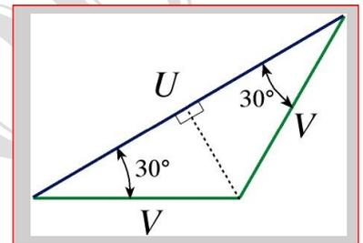
**Remarque :** Le réseau est caractérisé par ses deux tensions : tension simple et tension composée. Ces deux tensions sont dans le rapport de  $\sqrt{3}$ . On caractérise le réseau par sa tension composée qui est toujours présente, la tension simple n'existe que si le neutre est présent sur le réseau.
