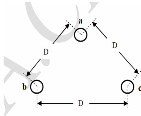
Les trois phases sont disposées en triangle équilatéral c'est à dire symétriques  $I_a + I_b + I_c = 0$
