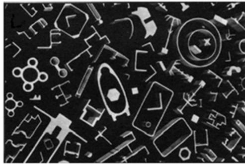
Figure. I. 28 : Exemple des pièces réalisées par filage
