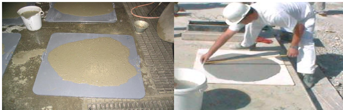
Figure : Mesure de l'affaissement sur table
