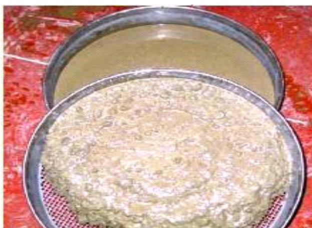
Fig:Dispositif de l'essai de stabilité au tamis
