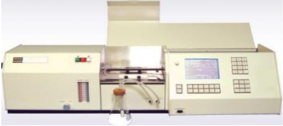
الشكل (7.II): استخدام طريقة البخار البارد
