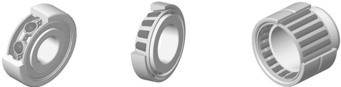
On appelle roulement un ensemble de pièces insérées entre deux organes mobiles l'un par rapport à l'autre et destinées à remplacer un frottement de glissement par un frottement de roulement. La puissance absorbée par la résistance au roulement est beaucoup plus faible que la puissance absorbée par la résistance au glissement. Tous les roulements exigent une très bonne coaxialité (arbre et alésage).
