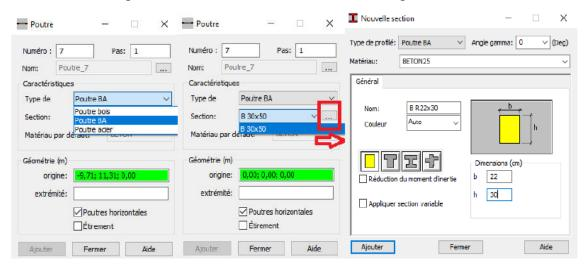
iv. Sur la nouvelle fenêtre, il est possible de modifier le type de profilé, le matériau et les dimensions...
