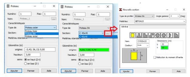
iv. Sur la nouvelle fenêtre, il est possible de modifier le type de profilé, le matériau, les dimensions...
