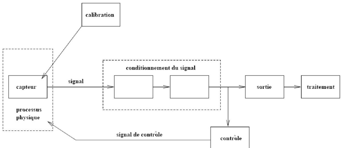
Schéma général d'un système de mesure
