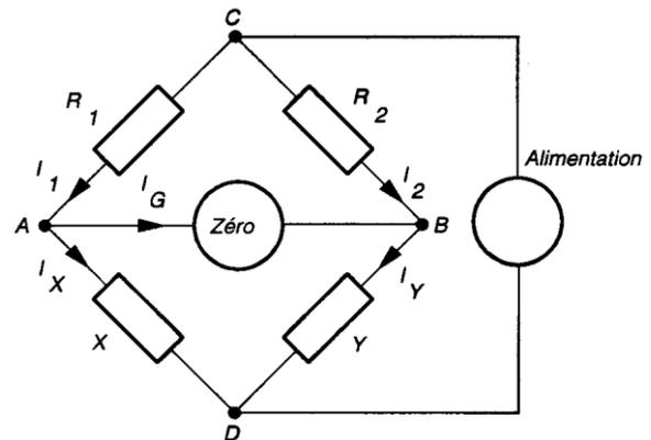
Dans les montages en pont on est ramené en fait à la comparaison des valeurs des grandeurs
