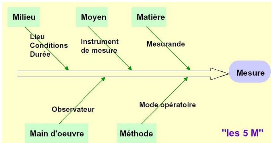
On explicite successivement, la contribution des **moyens**, de la **méthode de mesure**, l'impact du **milieu environnant** et de la **main d'oeuvre** (l'expérimentateur) sans oublier l'objet mesuré lui-même: le **mesurande**.
