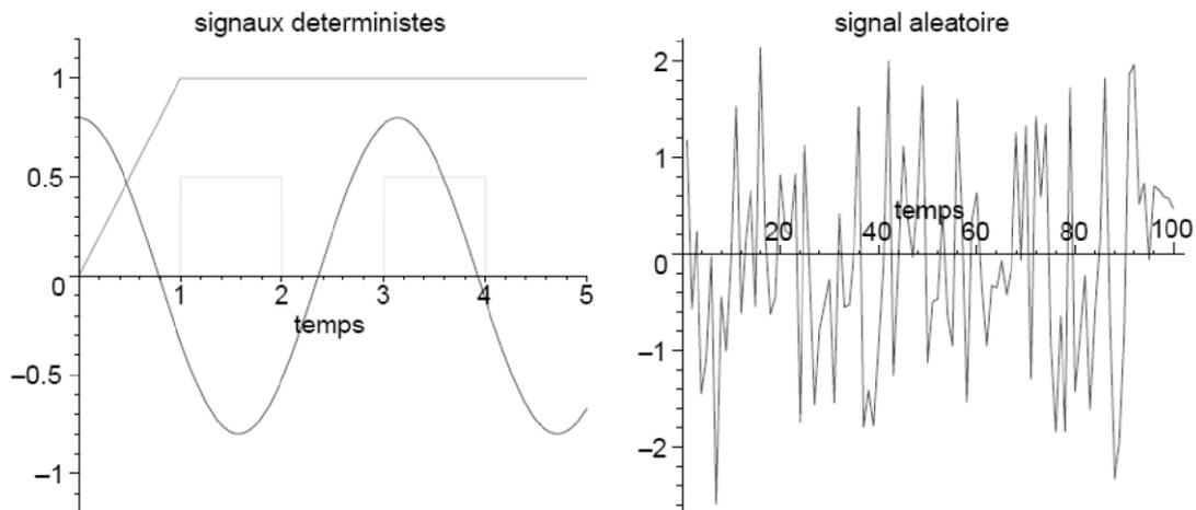
Les signaux de mesure sont généralement des signaux déterministes. Les bruits de mesure sont des signaux aléatoires qui s'ajoutent aux signaux à mesurer. Un signal d'interférence est plutôt un signal de type déterministe qui s'ajoute au signal à mesurer et qui le perturbe.
