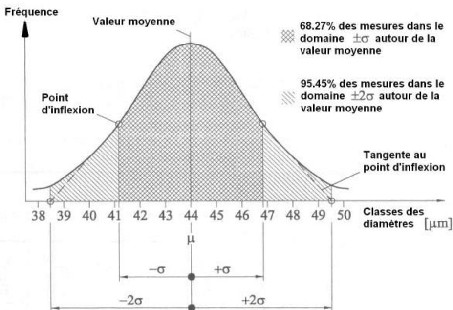
Dans le cadre de la technique de mesure industrielle, on travaille la plupart du temps avec un niveau de confiance de 95% respectivement avec le domaine de confiance  $\pm 1.96 \sigma$ .
