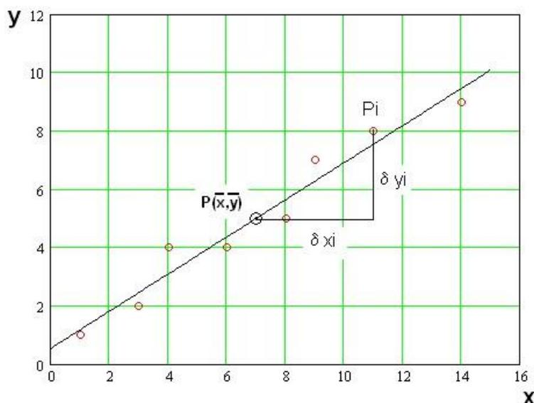
Etant données les erreurs aléatoires apparaissant sur les mesures de  $x$  et de  $y$ , il faut tenir compte de l'ensemble des mesures pour calculer  $a$  et  $b$ .
