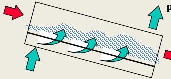
pression de 40 à 60 mb max sous la toile - UTILISER UNE BUSE SONIQUE pour limiter le débit La mauvaise ventilation ou le fait qu'elle soit trop remplie et trop petite peut créer des problèmes d'écoulement
