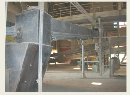
Système de transport pneumatique conçu pour le transport de matière pulvérulente d'un endroit élevé vers un autre plus bas
