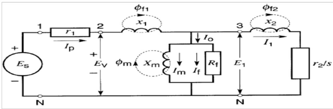
Figure 5 Schéma équivalent de la machine asynchrone
