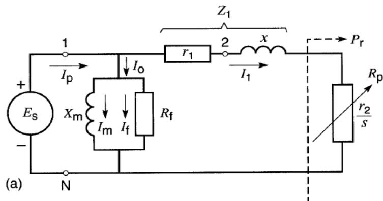
Figure 6 Schéma équivalent simplifié de la machine asynchrone
