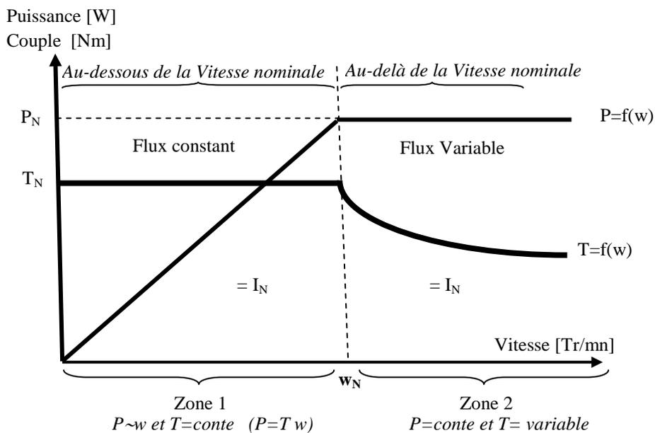
Zone 1 : dans cette zone on utilise le réglage de la vitesse par variation de la résistance ou par variation de la fréquence en gardant le flux constant. Dans ce cas on peut régler la vitesse de zéro jusqu'à la valeur nominale avec un couple nominal (le courant est aussi à sa valeur nominale).
