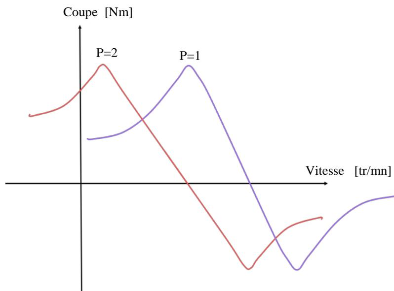
Figure Moteur à deux vitesses en changeant sa vitesse par connexion pour changer le nombre de paire de pôles
