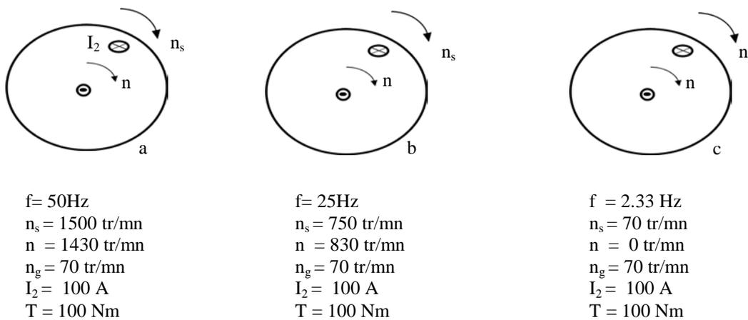
Figure 4 Flux constant : le couple et le courant dépendent uniquement de la vitesse de glissement
