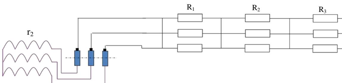
Figure Moteur à deux vitesses en changeant sa vitesse par connexion pour changer le nombre de paire de pôles
