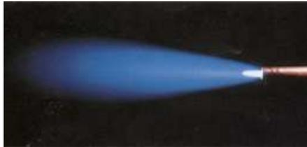
**Flamme oxydante :** c'est une flamme avec un excès d'oxygène. Le panache et le dard sont raccourcis. La flamme **émet un sifflement**. Le panache est plus lumineux.
