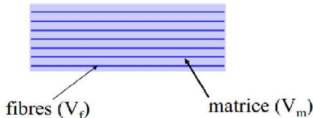
Structure d'un matériau composite
